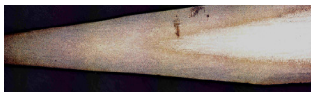
Rys. 8. Warstwa nawęglona po usunięciu pasmowości struktury
