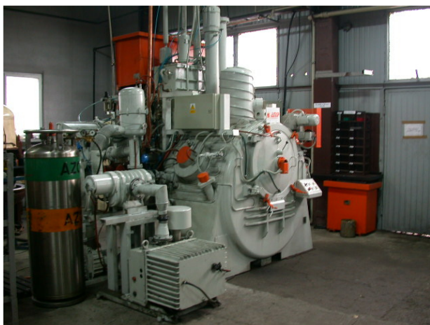
Rys. 1. Stanowisko do obróbki cieplnej w piecu próżniowym RVFOQ-224
