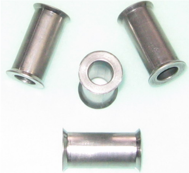
Rys. 4. Tulejki dwukołnierzowe spęczane na zimno w przyrządzie TR typu TRD8 na prasie mimośrodowej PMS160
