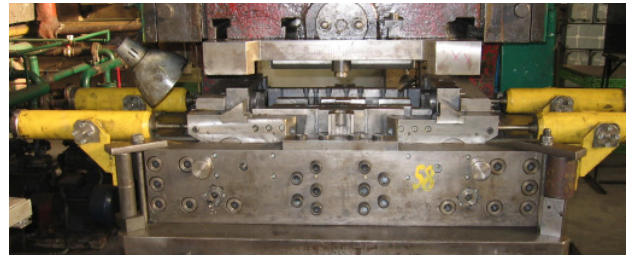
Rys. 6. Stanowisko do spęczania na zimno kołnierzy tulejek na prasie mimośrodowej PMS160
