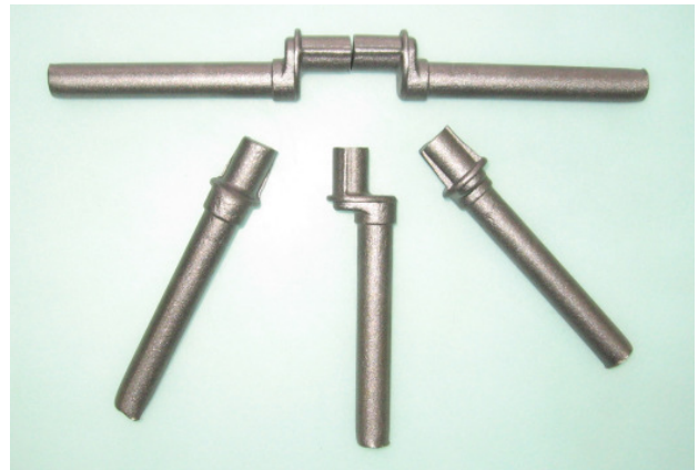
Rys. 3. Odkuwki wałka wykorbionego kute w przyrządzie TR typu TRL8/4 Fig. 3. A view of forgings made
